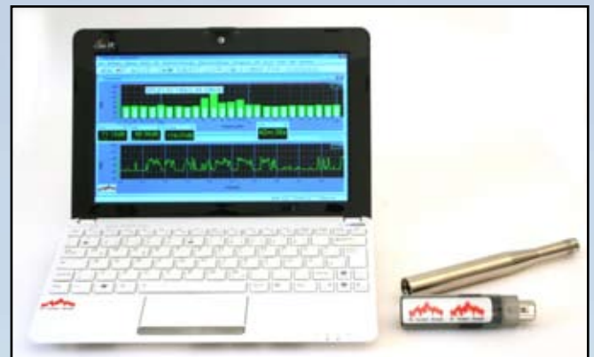
AkuLap mit Netbook und USB Messinterface ATD1 und Klasse 1 Mikrofon
