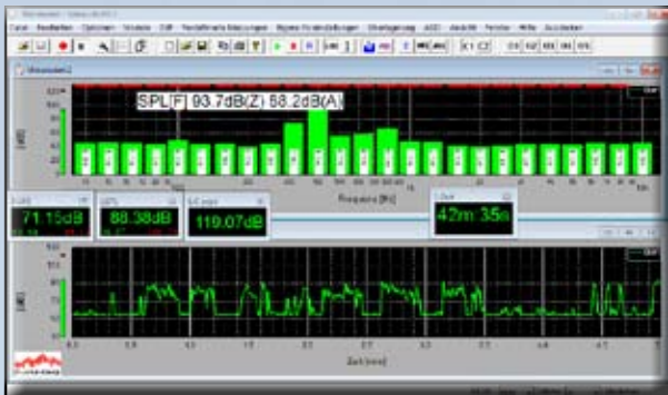
Display mit Echtzeitanalyse und Pegelzeitverlauf
