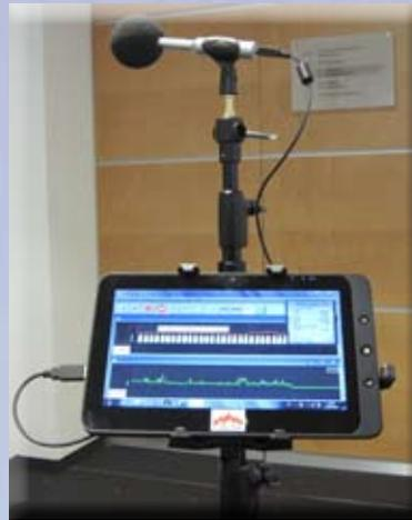
Bauakustische Messung mit einem Tablet PC
