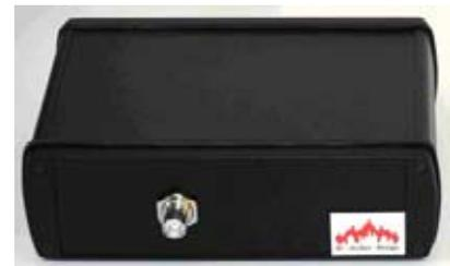
*ICP-Ultraschall- Messinterface zum Anschluss von ICP-Mikrofonen an einen PC über USB. Die analoge Bandbreite beträgt 96kHz. Das System verfügt über eine USB Anschluss und eine BNC-Buchse für das Mikrofon.*
