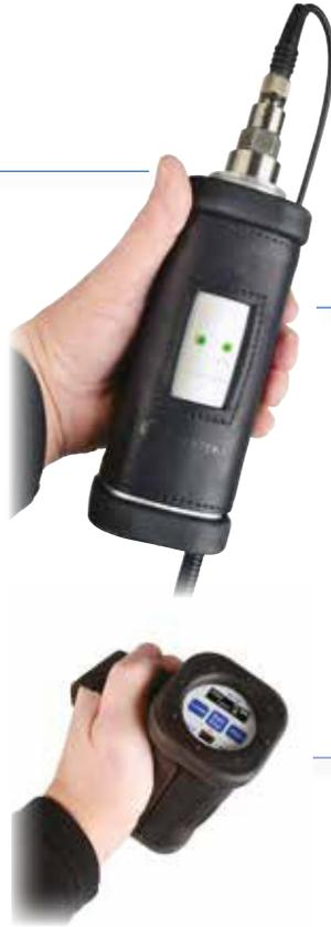
Zwei **LED - Dioden** zeigen den aktuellen Zustand während des Kalibriervorgangs an.
